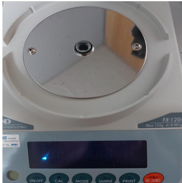
2. Setzen sie den Wiegeadapter auf die Waage, achten sie darauf, dass sich dieser vollständig in der Sensoraufnahme befindet. Wenden sie keine Kraft auf, der Adapter setzt sich ohne Kraftaufwand in die Waagenaufnahme.
