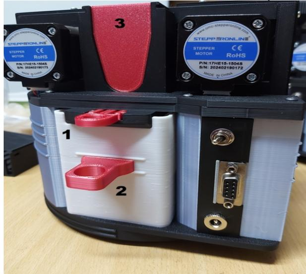
4. Schieben sie das Pulver-Vorratsrohr auf die Pulverkammer
